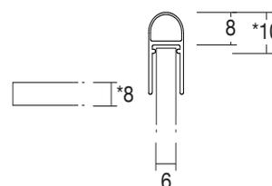
Art. Nr. Dichtungsprofil 180° | Glas
